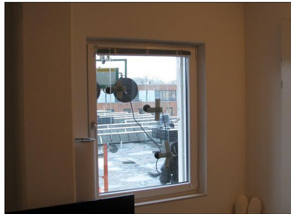
Foto II.2 Aanzicht microfoonposities in spouw
