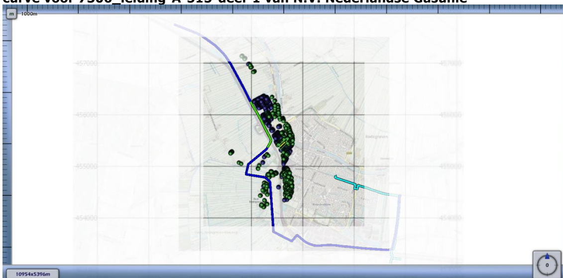
Figuur 4.2 Kilometer leiding behorende bij de maximale overschrijding van de FN-curve voor 7306_leiding-A-515-deel-1 van N.V. Nederlandse Gasunie
